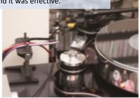
ケーブル固定に加え、新たに機器本体を支えるインシュレーターにも「NCF Booster効果」を実現するNCF Booster-Signal-L。角田氏は小型フォノEQ調整基で支持して常用すること。
